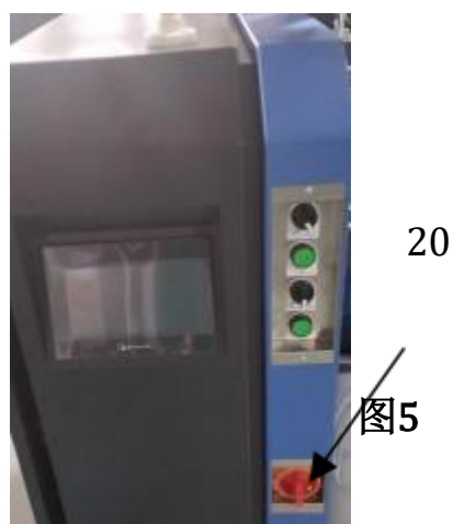
20- Главный выключатель питания
