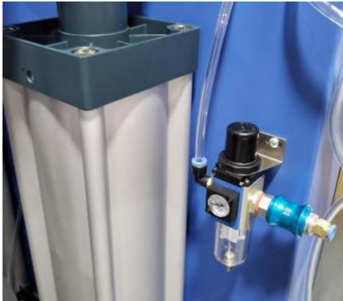
图 6 Регулировка и индикация общего давления воздуха
